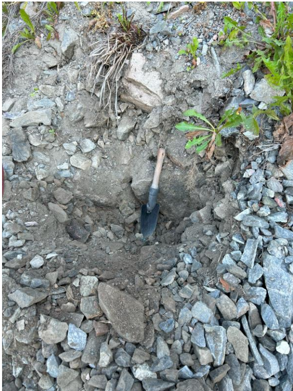
Figur 5. Prøvetaking fra østsiden av brua. En god del fraksjoner > 10 cm, noe mindre fraksjoner lenger ned.
