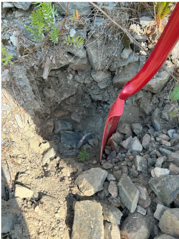
Figur 3. Prøvetaking. Store mengder større fraksjoner/kult fra erosjonssikring på eksisterende bru.
